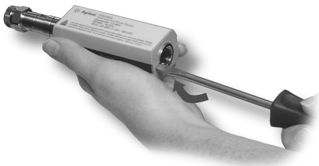
図 12 パワーセンサ外装の取り外し
